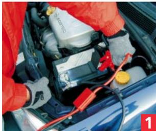
(Explosionsgefahr!). Der Motor des stromgebenden Fahrzeugs sollte laufen, eventuell sogar mit etwas höherer Drehzahl. **Vorsicht** an sich drehenden Teilen (Kühlventilator, etc.).
