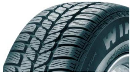
merreifen bestückter Pkw aus nur 50 km/h erst nach 43 Metern zum Stehen kommt, während bei aufgezogenen Winterreifen 35 Meter zum Anhalten ausreichen! Im Ernstfall schlägt in diesem Vergleich der mit Sommerreifen bestückte Wagen noch mit respektablen 22 km/h auf ein Hindernis auf, während das Fahrzeug mit Winterreifen sicher und unbeschadet an diesem Punkt bereits zum Stehen kam.
