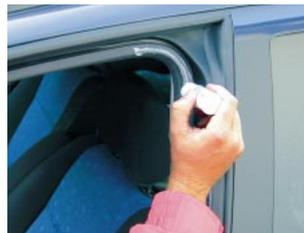
kann verhindert werden, dass die Gummilippen am Blech anfrieren. Besonders wichtig ist die Schutzschicht an den Dichtgummi rahmenloser Seitenscheiben.
