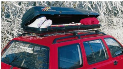
**Montage:** Die richtige Position der Dachbox ist **mittig auf den Grundträgern**. So verteilt sich das Gewicht gleichmäßig. Bitte beachten Sie, dass die Funktion der Heckklappe nicht behindert wird.
